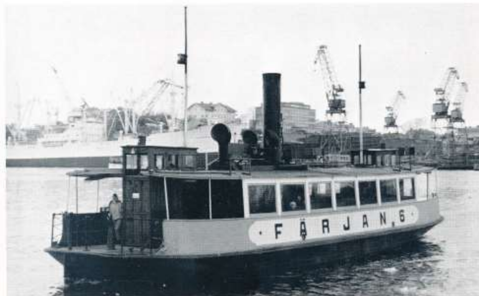
FÄRJAN 6 skilde sig från de andra ångfärjorna genom större fönster och högre skorsten. Foto från Bertil Söderberg.
